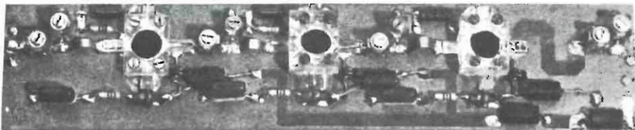
Fig. 13 - Prototipo di laboratorio dell'amplificatore descritto. I collegamenti al piano inferiore della piastra (massa) vengono effettuati mediante rivetti tubolari da 2 mm che vengono saldati al rame inferiore della piastra stessa. I collegamenti di ingresso e di uscita dell'amplificatore vengono effettuati saldando direttamente il cavo coassiale ai rivetti (massa) e alle aree metallizzate (segnale) del circuito stampato. In questo prototipo di laboratorio, i transistori sono stati fissati mediante blocchi di materiale acrilico onde consentire la loro sostituzione in caso di misure, prove ecc...
